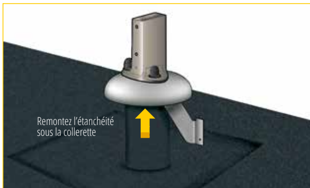
7 - Opérez votre isolation + relevé d'étanchéité. > Modèle sans manchon : effectuez votre relevé d'étanchéité jusqu'au dessous de la colerette.
