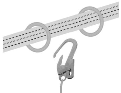
Per cui in qualsiasi momento solo una persona e/o un utilizzatore potrà essere fissato/attacco ad ogni singolo O-ring.
