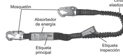
Los cabos anticaídas están fabricados en cinta de poliéster (elastizada o plana) o aramida (elastizada). La cinta interior del absorbedor de energía esta fabricada en poliéster. Contiene en sus laterales un banda de color roja como indicador de caídas.
