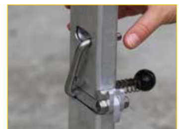
4. Enclencher la manette dans le logement en relâchant la poignée (le logement est muni de crans) de verrouillage, afin de verrouiller complètement le montant, puis pousser la manette côté extérieur jusqu'au dernier cran. Le système est alors entièrement verrouillé.
