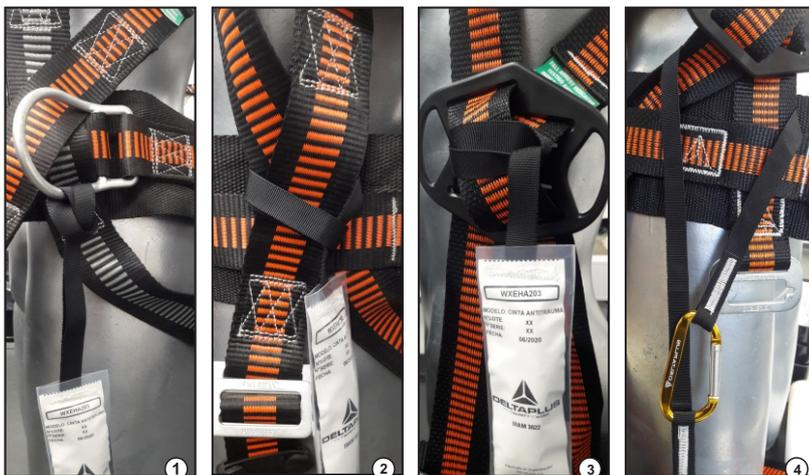
\*En el caso de la figura Nro.1 (Conexión en argolla "D", argollas de posicionamiento) se debe considerar el potencial roce con mosquetones y conectores que puedan dañar o enganchar la cinta de este dispositivo antitrauma, perjudicando y afectando su correcto funcionamiento.
