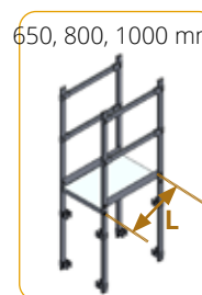
WV6240xxx Verbrede uitgang met afdaling van dakrand, breedte 650 mm, 800 mm & 1000 mm
