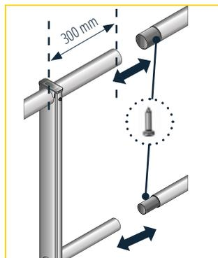
11 - Assembler les lisses et sous-lisses des tronçons montés avec vis 4,8x16.
