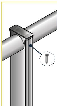
10 - Visser les vis autoforeuses 4,8 x 25 sur le montant au niveau de la lisse et de la sous lisse
