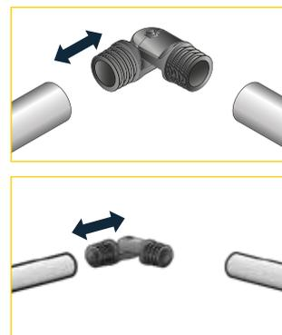
12 - Insérer les angles des lisses et des sous-lisses.
