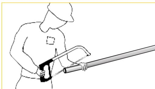
14 - Ajuster le dernier tronçon en sciant l'excédent rétreint.
