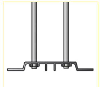
1 - Tracez un repère tous les 1500 mm au maximum. \*Pour La cote en angle entre le montant et le bord de l'acrotère se référer au plan de calepinage page précédente. 2 - Enfilez les tiges filetées sur la plaque de fixation
