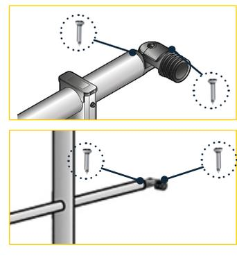
13 - Fixer les angles avec les vis autoforeuses 4,8 x 25.
