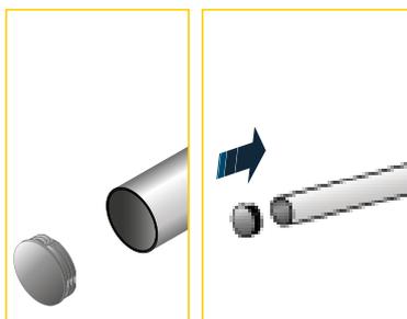
15 - Enfin, insérer les bouchons ou les terminaisons murales aux lisses et sous-lisses.
