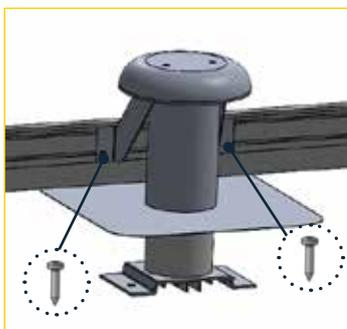
1 - Fixez la plinthe au support avec 2 vis autoforeuses 4.8 x 16 (1 de chaque côté du support).
