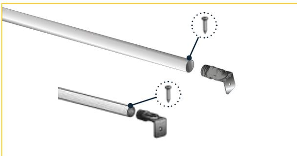
1 - Fixer les terminaisons murales à l'aide des vis autoforeuses 4.8 x 25
