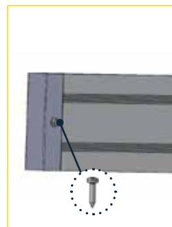
4 - Enfin, fixer les bouchons de plinthe avec 1 vis autoforeuse TH 4.8 x 16
