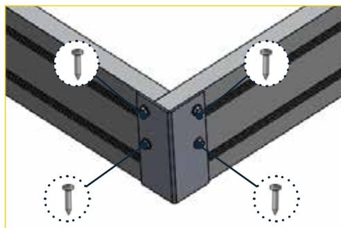
3 - Pour les angles, fixer le raccord extérieur d'angle de plinthe avec 4 vis autoforeuses TH 4.8 x 16
