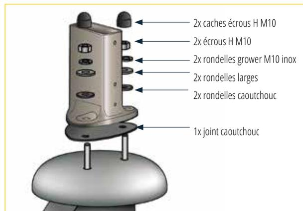
6 - Enfin, enfilez le joint caoutchouc sur les tiges filetées puis l'embase à plat. Fixez l'embase à l'aide des 2 écrous H M10 en associant correctement les rondelles caoutchouc, les rondelles larges, les rondelles grower et les caches écrous.
