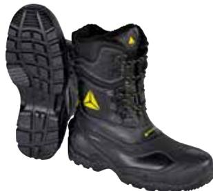
Botas forradas de segurança. Cano: PU e poliéster. Forro: Membrana de poliéster impermeável DELTA-TEX™ e forro SNOWTEX™ + gola poliéster forrada. Palmilha interior: Amovível preformada - feltro. Sola: injectada - PU bi-densidade resistente a -30°C. Bota não magnética.
