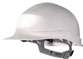
Capacete de estaleiro em polipropileno (PP) ou polietileno alta densidade (HDPE), tratamento anti-UV. Coifa polietileno (LDPE), com 8 pontos de fixação. Banda de suor em esponja. Aperto deslizante ajustável: perímetro da cabeça de 53 a 63 cm. Isolamento eléctrico até 1000 VAC ou 1500VCC. Furo standart para acessórios. Encaixes para francaletes de 2 ou 4 pontos.
