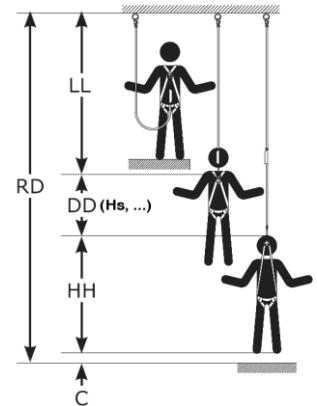
El rendimiento del sistema de absorción de energía / dispositivo de detención de caídas. (ver **ESPECIFICACIONES:** ⑨)
