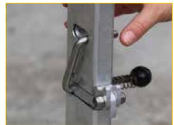
4. Rasten Sie den Hebel im Gehäuse ein, indem Sie den Verriegelungsgriff loslassen (das Gehäuse ist mit Kerben versehen), um den Pfosten vollständig zu verriegeln, und drücken Sie dann den Hebel mit der Außenseite bis zur letzten Kerbe. Das System ist dann vollständig verriegelt.
