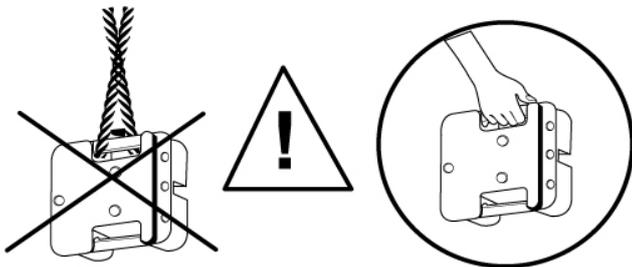
**INTERDICTION** d'utiliser les poignées du plot pour le levage sur toiture
