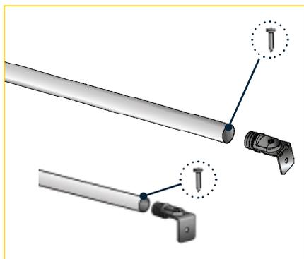
1 - Fixer les terminaisons murales à l'aide des vis autoforeuses 4.8 x 25
