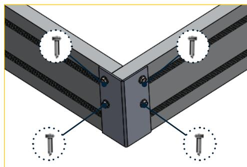
3 - Pour les angles, fixer les raccords intérieurs et extérieurs d'angle de plinthe avec 8 vis autoforeuses TH 4.8 x 16
