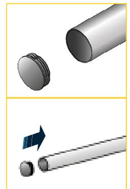
13 - Insérer les bouchons ou les terminaisons murales aux lisses et sous-lisses.
