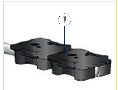
8 - Une fois l'ensemble de garde-corps monté, visser les vis autoforeuses 4,8x50 comme indiqué ci-dessus
