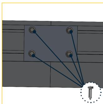
2 - Joindre les longueurs de plinthe entre elles grâce aux raccords de plinthe et aux 4 vis autoforeuses TH 4.8 x 16
