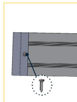
4 - Enfin, fixer les bouchons de plinthe avec 1 vis autoforeuse TH 4.8 x 16
