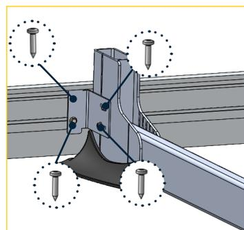
1 - Ôter les vis cuvettes M8x10 pré-montées sur l'embase à plat et placer les supports de plinthe sur l'embase. La fixer ensuite avec 2 vis autoforeuses 4.8x25. Puis enfin, fixer la plinthe au support avec 2 autres vis autoforeuses 4.8 x 16
